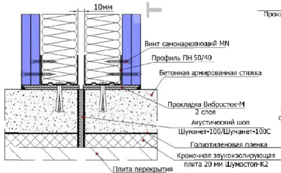
1.2.5 Примыкание перегородки на двойном 2x50 мм (независимом) каркасе к конструкции "плавающего" пола
