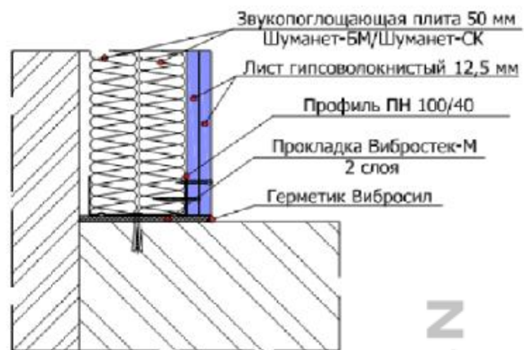
3.1.7 Примыкание облицовки стены на независимом каркасе 100 мм к перекрытию пола/потолка
