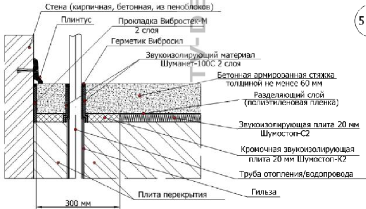
5.2.3 Схема примыкания конструкции плавающего пола с применением звукоизолирующих плит Шумостоп в один слой к стене и трубе отопления/водопровода
