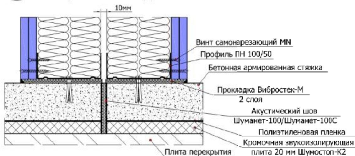
1.3.3 Примыкание перегородки на двойном 2x100 мм (независимом) каркасе к конструкции "плавающего" пола
