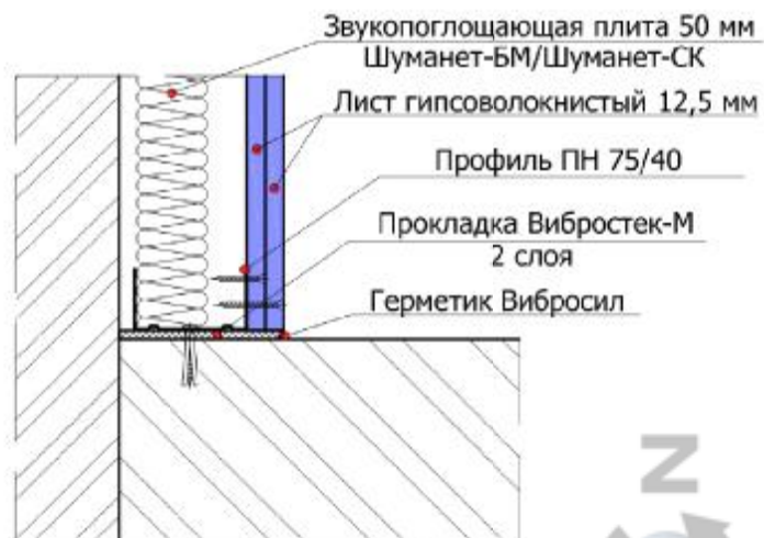
3.1.6 Угловое примыкание облицовки стены на независимом каркасе 75 мм к панелям ЗИПС на стене и дверному проему
