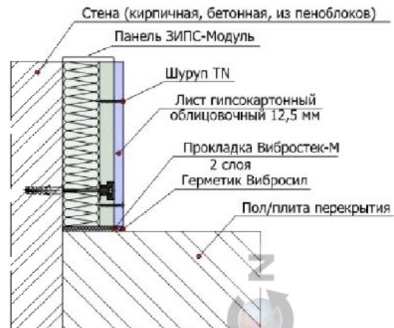
2.1.7 Примыкание панелей ЗИПС-Модуль к перекрытию пола/ потолка
