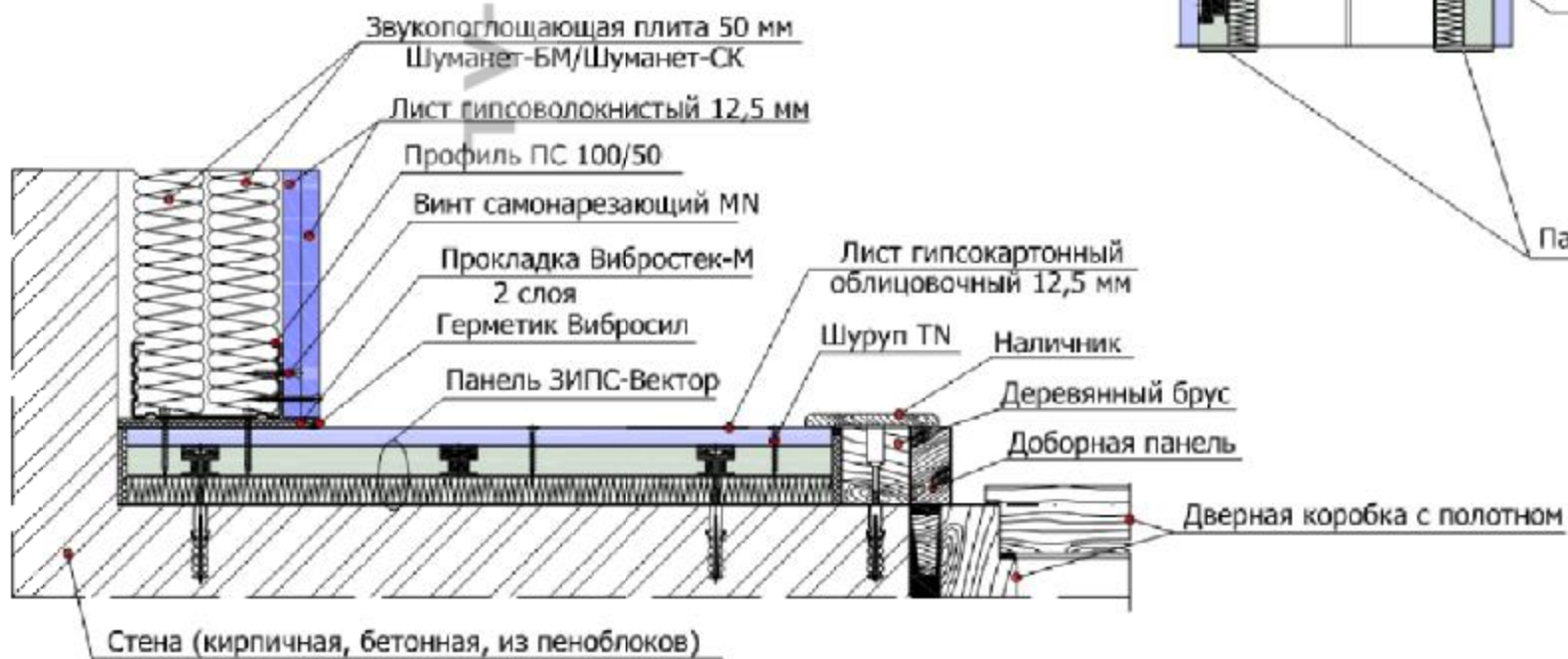
2.1.6 Угловое примыкание панелей ЗИПС-Вектор на стене к облицовке на каркасе 100 мм и дверному проему
